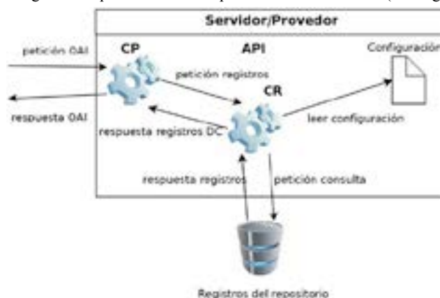
Fig. 2. Esquema de la arquitectura propuesta: componente de procesamiento (CP) y de recuperación (CR).
