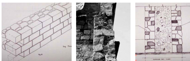
Izquierda: Figura 13. Muro compuesto por sillares y piedra irregular de cantería. 149
